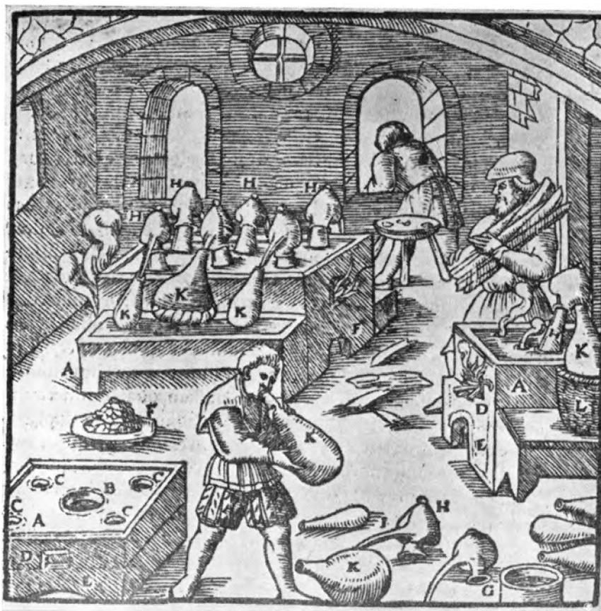
Получение кислот (соляной и азотной) перегонкой. Рисунок из книги «О горном деле и металлургии» Георгия Агриколы. А — печь; В — круглое отверстие; С — отверстие для воздуха; D — отверстие топки; E — поддувало; F — тигель; G — коилба; H — перегонный шлем; I — его клюв; K — приемник; L — корзина, в которую ставят приемники.
